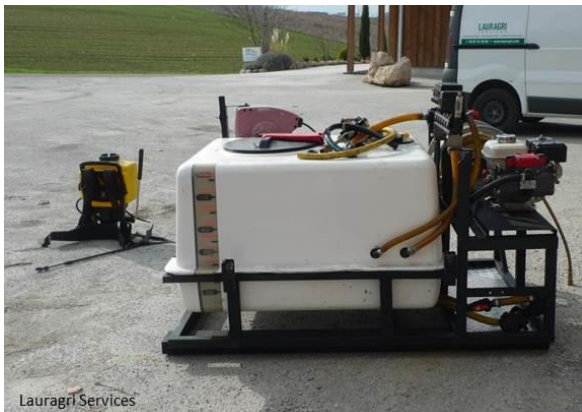
Figure 2 : Matériels utilisés pour la famille désherbage chimique. A gauche : modalité chimique foliaire référence dispensée par une pompe à dos pour la pulvérisation manuelle (présent sur la photo également : cuve pour la pulvérisation tracté); à droite : modalité pulvérisation chimique foliaire par détection opto-électronique.
