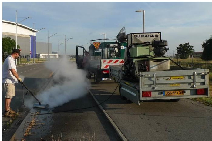
Figure 3 : Matériels utilisés pour la famille désherbage thermique. En haut à gauche : modalité eau chaude. En haut à droite : modalité brûleur à gaz à flamme directe. Ci-contre : modalité vapeur.
