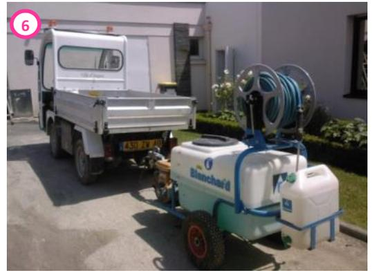
Figure 1 : Exemples de matériels de désherbage chimique
